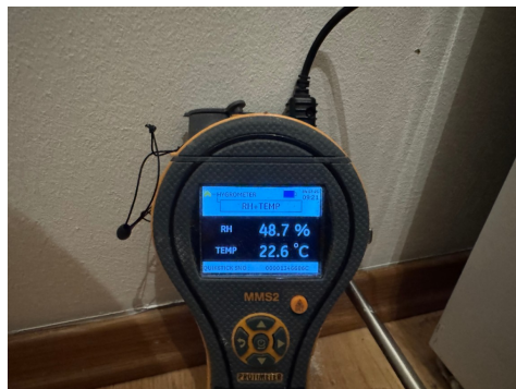
Måling av relativ luftfuktighet.
