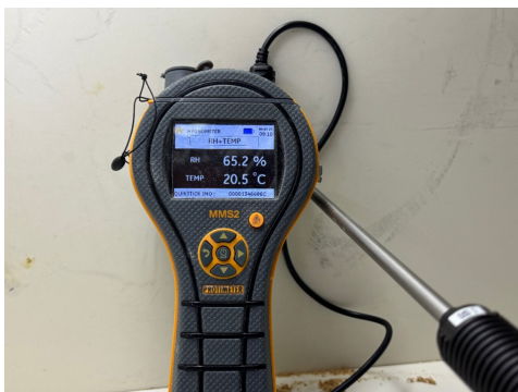
Måling av relativ luftfuktighet.
