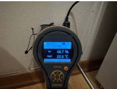
Måling av relativ luftfuktighet.
