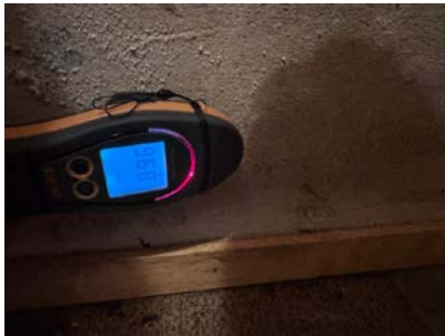
Forhøyede fuktverdier på innside av grunnmur i bod.
