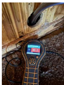
Måling av trefukt i lukket veggkonstruksjon under terreng.
