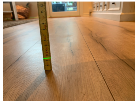
15mm retningsavvik på en lengde gjennom rommet
