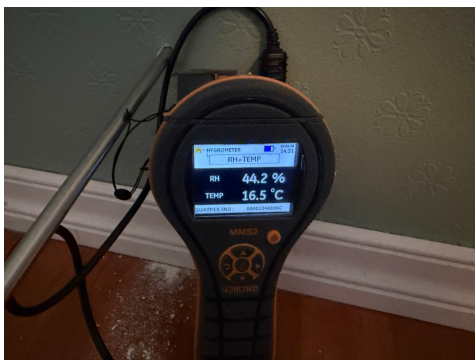
Måling av relativ luftfuktighet.
