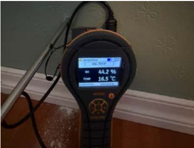
Måling av relativ luftfuktighet.
