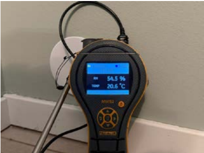
Måling av relativ luftfuktighet.
