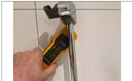
Kontroll med fuktmåler i dusjsone på bad i U.etasje.
