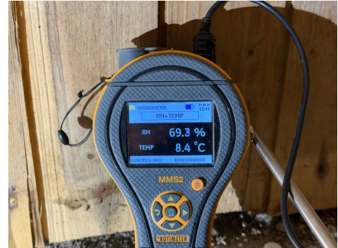
Måling av relativ luftfuktighet.
