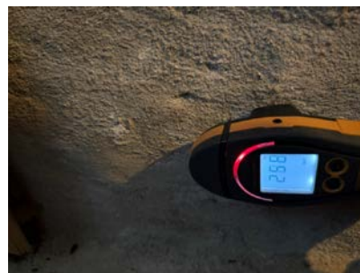
Forhøyede fuktverdier på innside av grunnmur i u-etg.
