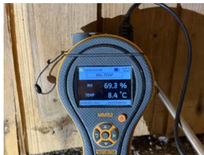
Måling av relativ luftfuktighet.
