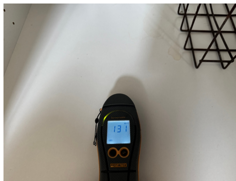
Ingen forhøyede fuktverdier ble registrert i kjøkkenbenken.
