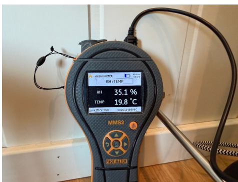
Måling av relativ luftfuktighet.
