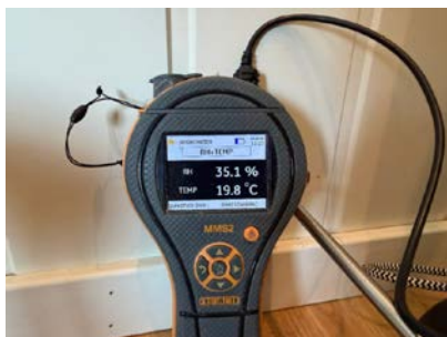
Måling av relativ luftfuktighet.
