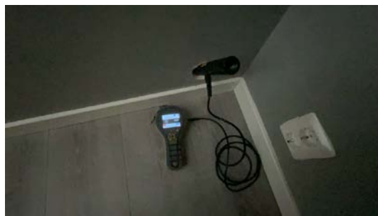
Utført hulltaking på rom under terreng.
