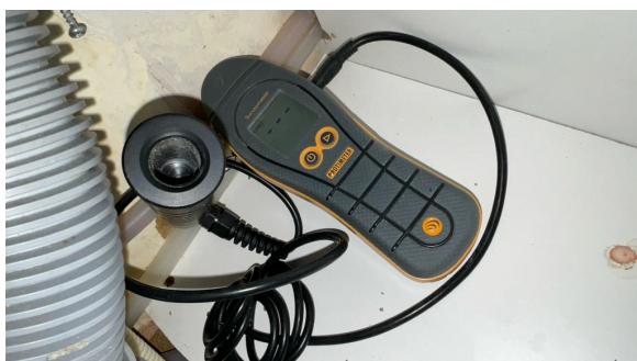
Hulltagning og fuktsøk
