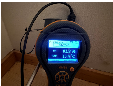
Måling av relativ luftfuktighet.
