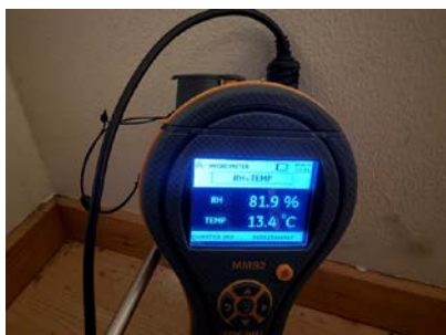
Måling av relativ luftfuktighet.
