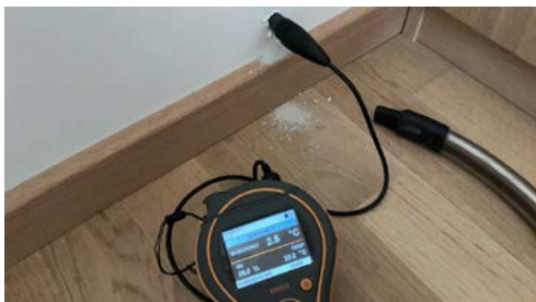
Måling av relativ luftfuktighet i lukket veggkonstruksjon mellom tiliggende soverom og våtsone
