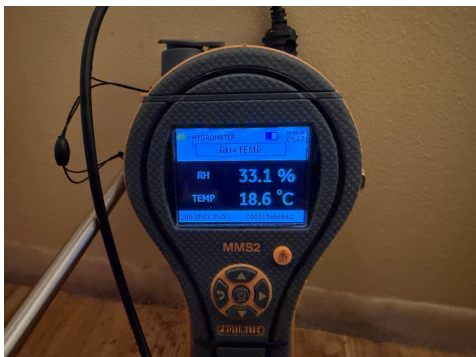
Måling av relativ luftfuktighet.
