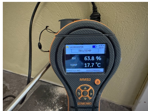
Måling av relativ luftfuktighet.
