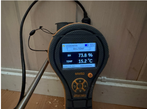
Måling av relativ luftfuktighet.
