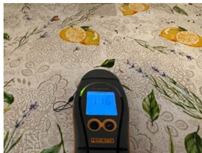
Ingen forhøyede fuktverdier ble registrert i kjøkkenbenken.
