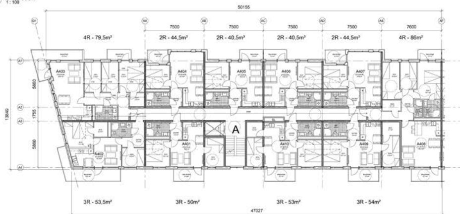
1 Plan 4 (Typisk 3.-6. Etasje) - bygg A - rammesøk 1:150
