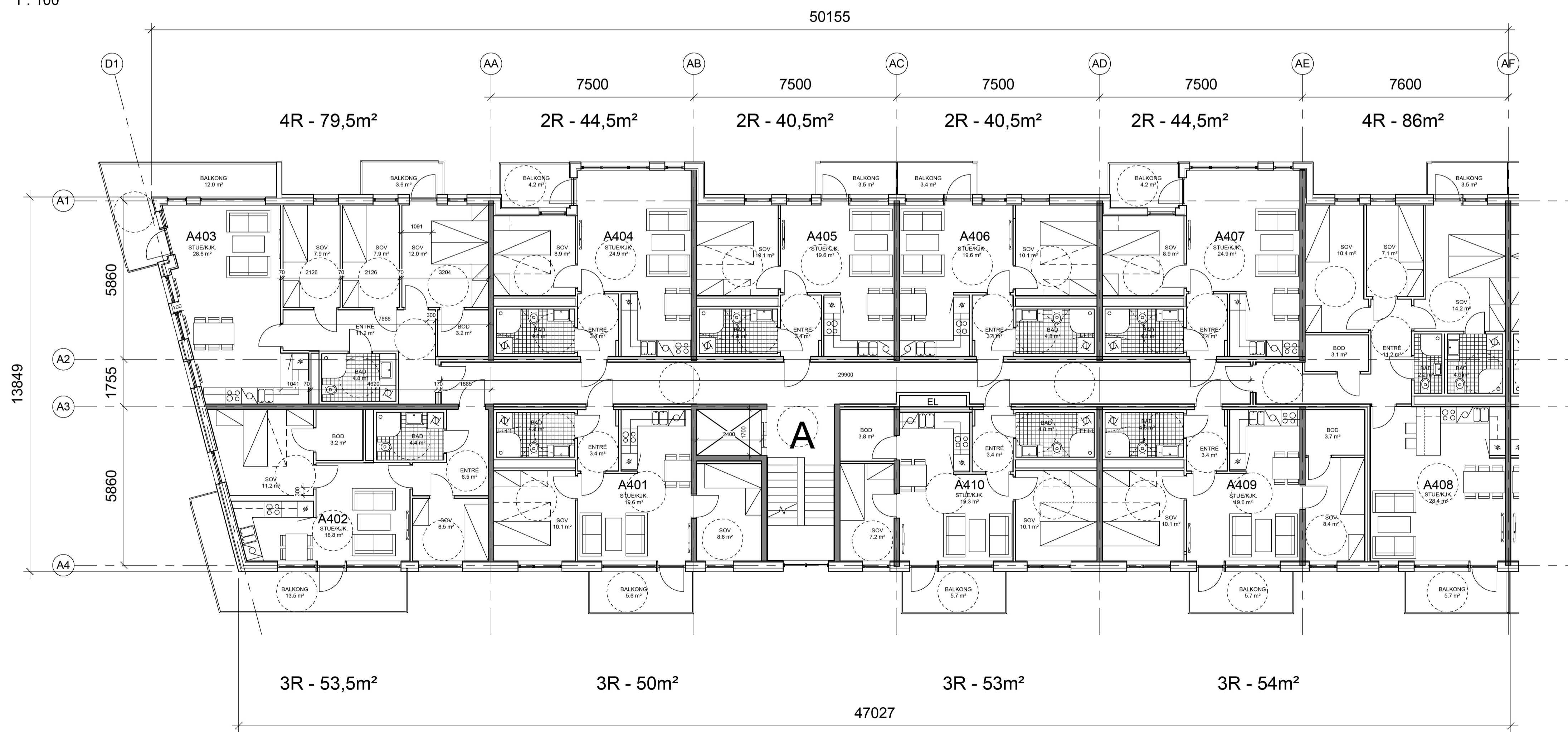
1 Plan 4 (Typisk 3.-6. Etasje) - bygg A - rammesøk 1:100
