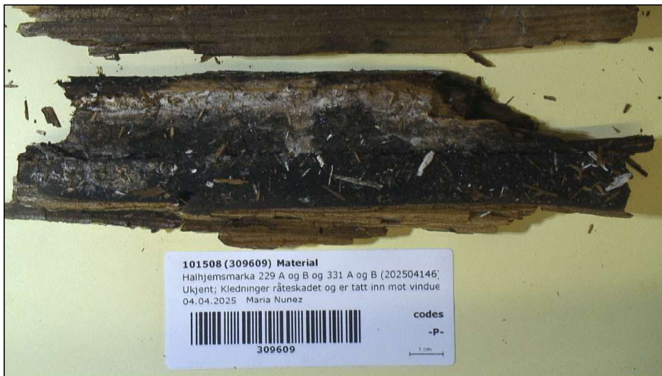
Foto 2. Prøve 309609. Tremateriale, kledning inn mot vinduer.
