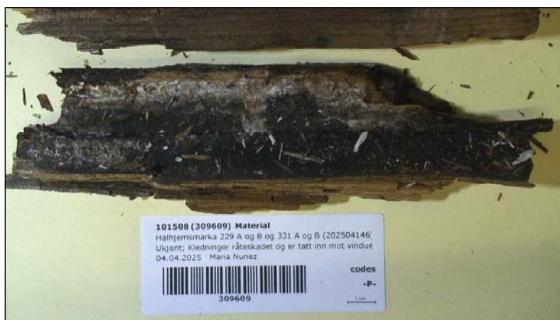
Foto 2. Prøve 309609. Tremateriale, kledning inn mot vinduer.
