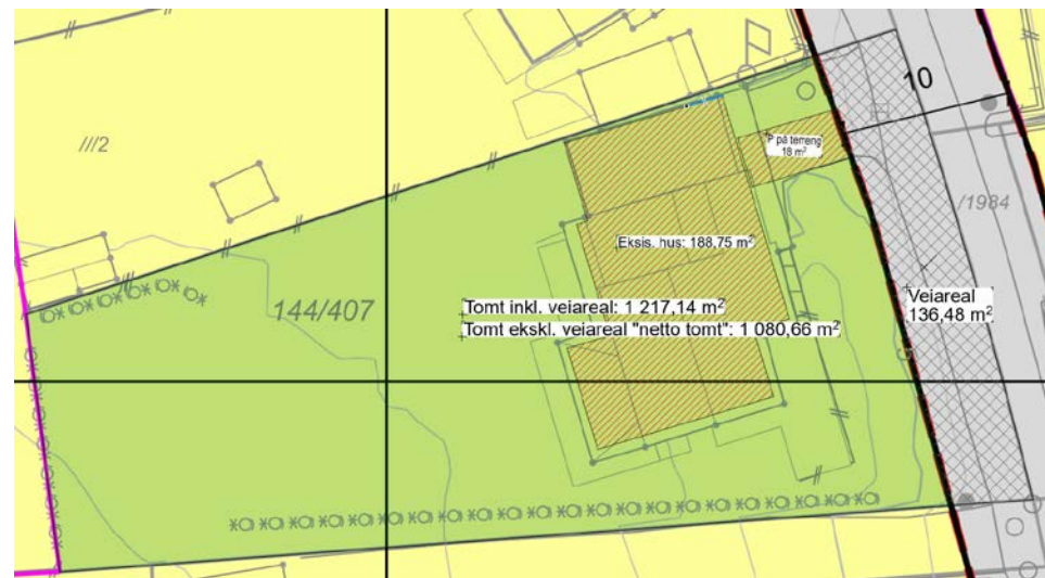
Figur 1, tomtestørrelse og utnyttelse i eksisterende situasjon.
