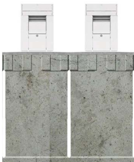
Dypoppsamlere har beholdere under bakkenivå.
