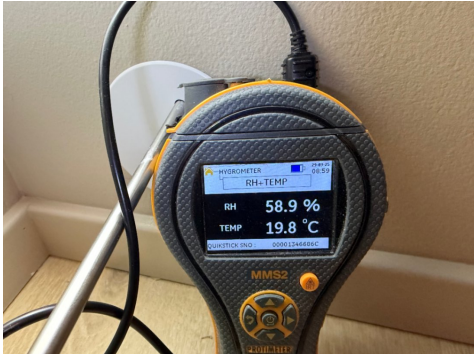
Måling av relativ luftfuktighet.
