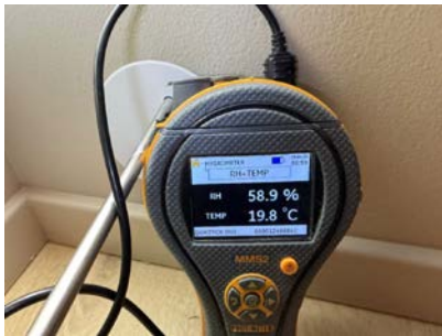
Måling av relativ luftfuktighet.
