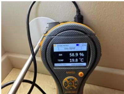
Måling av relativ luftfuktighet.
