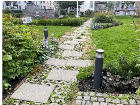
Pullertbelysning er utsatt for jordfeil
