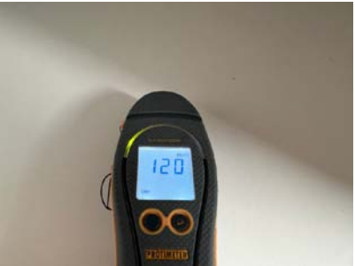
Ingen forhøyede fuktverdier ble registrert i kjøkkenbenken.
