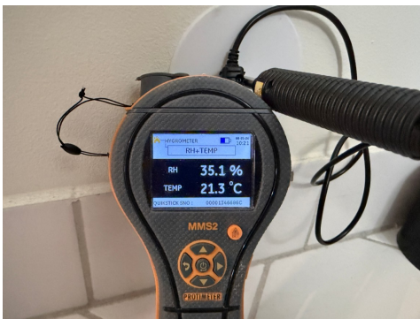
Måling av relativ luftfuktighet.
