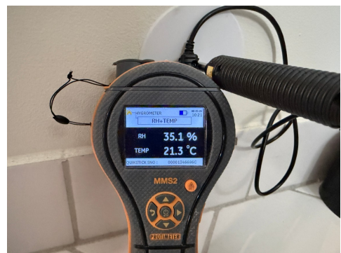
Måling av relativ luftfuktighet.
