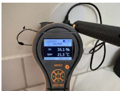
Måling av relativ luftfuktighet.
