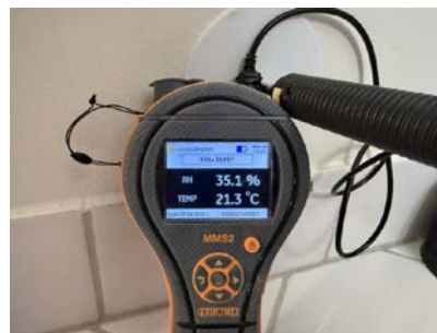
Måling av relativ luftfuktighet.
